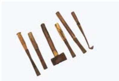
勾缝刀、铲缝刀、捻缝锤
